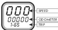
Die Einstellung "1-65" ist für Motorräder mit 120/70-17 Vorderrad geeignet.
