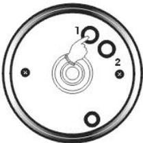
Drücken Sie zum Einstellen des korrekten Wertes den Set-Knopf (1).
