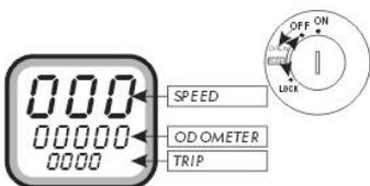
Nach der Geschwindigkeits-Einstellung Zündung aus- und einschalten um in den Standard-Anzeigemodus zu gelangen.
