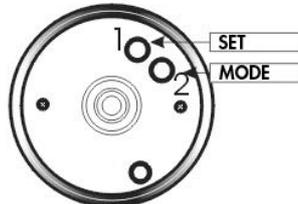
Drücken Sie die Einstellknöpfe auf der Gehäuserückseite gleichzeitig. Bei gedrückten Knöpfen die Zündung zweimal an- und ausschalten.
