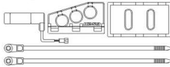
Sensorhalter an der Gabel montieren und das Sensorkabel mit Kabelbinder an der Gabel fixieren. Den Sensor in Höhe und Winkel ausrichten.
